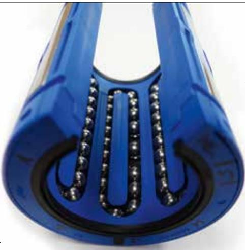
◀ Fertig montiertes Linearkugellager. Der Schlussring übernimmt im Betrieb zwei Funktionen: Abdichtung gegenüber der Welle und Umlenkung der für die Linearbewegung benötigten Kugeln.
